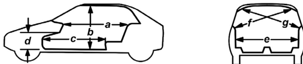
$a$  – расстояние между приборной доской и верхней частью заднего сиденья;  $b$  – расстояние между крышей и панелью пола;  $c$  – расстояние между задним сидением и панелью двигателя;  $d$  – расстояние между нижней частью приборной панели и панелью пола;  $e$  – внутренняя ширина;  $f$  – расстояние между нижним краем левого окна и верхним краем правого окна;  $g$  – расстояние между нижним краем правого окна и верхним краем левого окна
