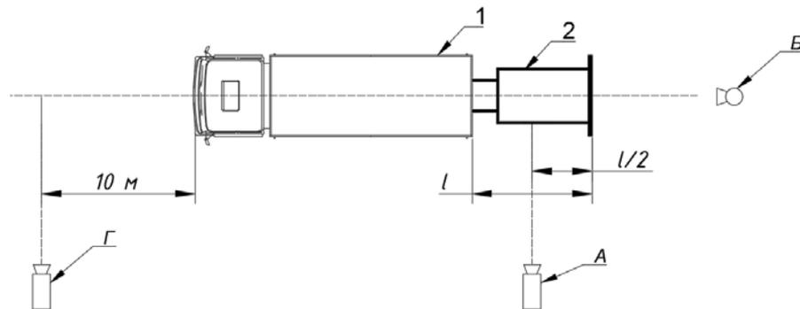
*А* – высокоскоростные видеокамеры; *Б*, *Г* – панорамные видеокамеры, 1 – автомобиль прикрытия, 2 – мобильное фронтальное ограждение *l* – длина мобильного фронтального ограждения
