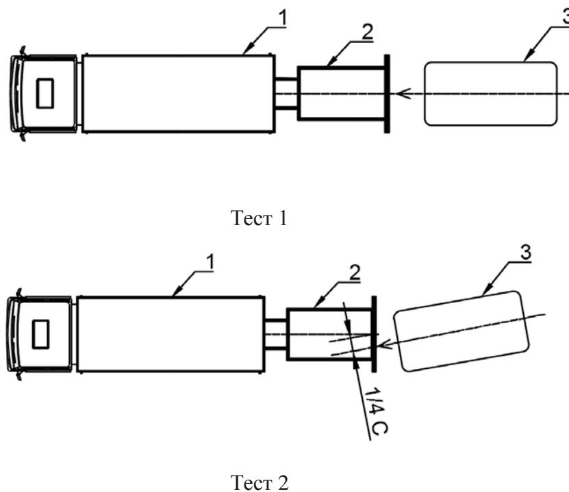
1 – автомобиль прикрытия, 2 – мобильное фронтальное ограждение,
