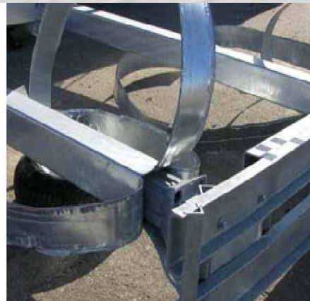
Сердечник разрывает трубу, в результате чего гасится энергия, на выходе получаются 4 полоски металла
